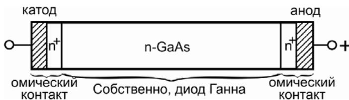
Рис. 2.1. Структура GaAs диода Ганна. Система слоев  $n^+$ -Au реализует омический контакт
